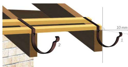
Obr. 7 – umístění háků do krokví, ohyb od objektu
