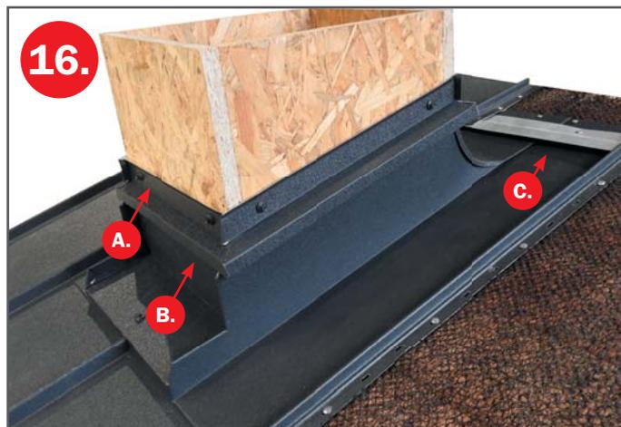
A. Zatmelit | B. Dilatační lišta | C. Spojovací plech Rapid (SPR)
