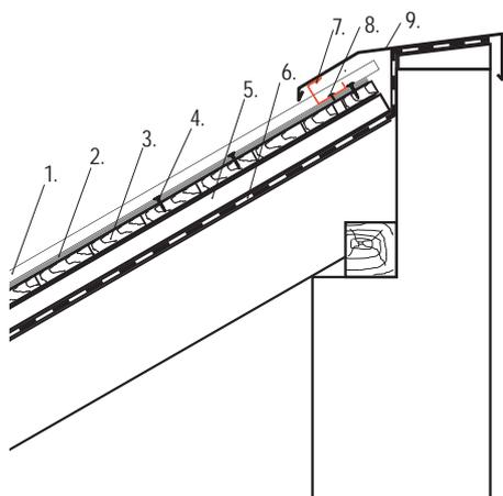
9. Před montáží závětrné lišty je nutné ohnout okraj krytiny nahoru o min. 30 mm. Tento ohyb bude překryt závětrnou lištou a zajistí odvod vody. Závětrnou lištu horní kotvěte do předem osazené dřevěné lišty namontované ve spádnici na latích. Kotvení závětrné lišty je nutné z boku i shora. Obdobným způsobem jsou osazeny a ukotveny oplechování ke zdi.
