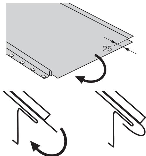
táž úžlabí provádíme vždy na bedněni, nebo na hustý rošt z latí, nebo prken. Přesah jednotlivých dílů úžlabí je min. 300 mm.
