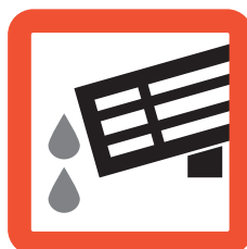
Při skladování vyspádovat pro odtékání vody
